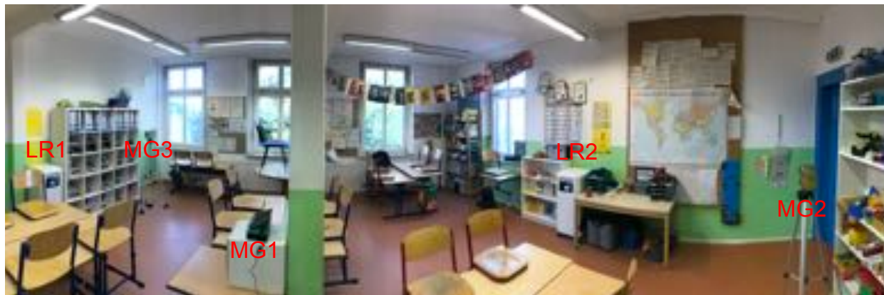
Abb. 1: Panorama-Foto des untersuchten Klassenraums (LxBxH 7 m x 6,7 m x 3 m) mit Messgeräten (MG) und Luftreinigern (LR)
